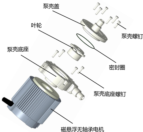
图3:磁悬浮无轴承泵的泵头爆炸图
